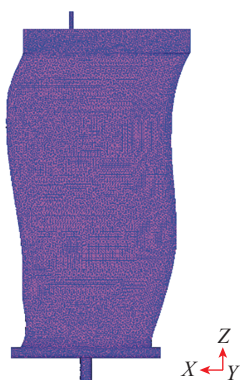
图 18 空心叶片有限元网格划分
